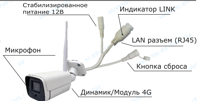
Рис. 1 Схема подключения видеокамеры
